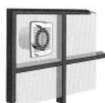
Instalación a ventana.
